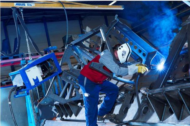
**Abb. 3:** Mit qualifizierten Schweißern und den zurzeit modernsten MIG/MAG-Schweißverfahren erzielt MBH auf wirtschaftliche Art höchste Qualität: Die Schweißnähte zeichnen sich durch sehr sicheren Einbrand, gute Wurzel- und Flankenerfassung aus – Bindefehler sind nahezu ausgeschlossen
