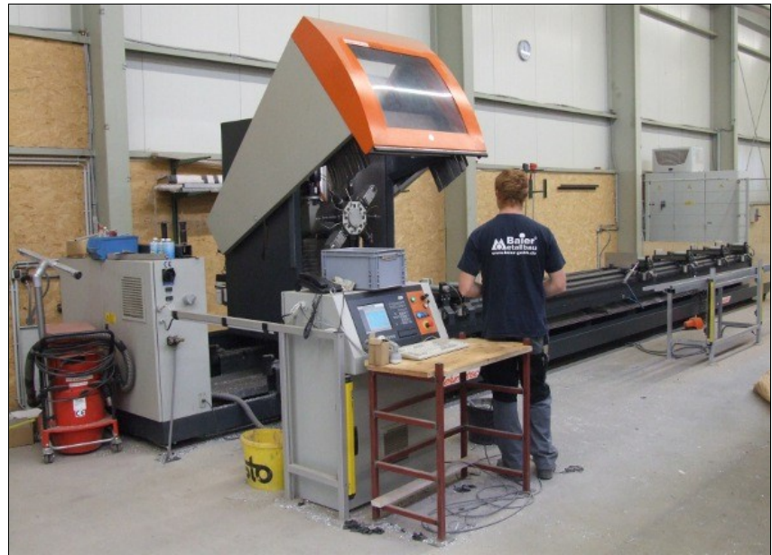
Baier hat auch zwei 3-Achs-Stabbearbeitungszentren SBZ 130 von elumatec im Einsatz. Die Maschine wird unter anderem für die Bearbeitung von Profilen aus Stahl genutzt.
