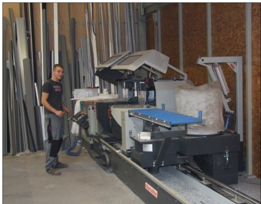
Doppelgehrungssäge DG 244 von elumatec: Die Sägeaggregate sind universell neig- und schwenkbar. Auch hohe und breite Profile lassen sich hier sägen.
