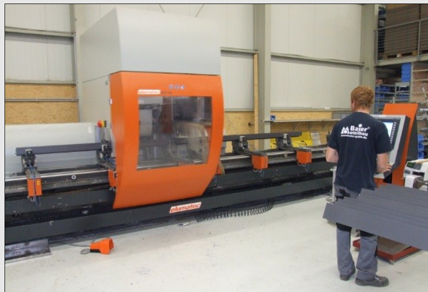
5-Achs-Stabbearbeitungszentrum SBZ 151 von elumatec: Bearbeiten und Sägen in einer Aufspannung. Auch Kleinteile lassen sich schnell anfertigen.
