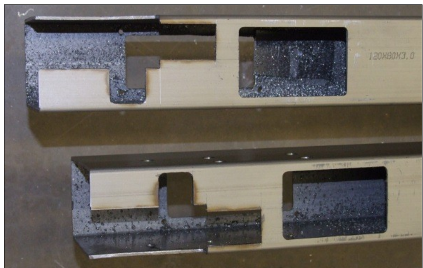
Stahlbearbeitung auf elumatec-Maschinen: Je nach Modell gibt es Ausstattungen wie Langsamlaufspindel, Spindelkühlung, Extra-Ablageplatz für's Stahlsägeblatt.
