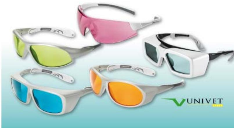
Neu sind dabei die Filter mit Interferenzschichten, die Laserstrahlen in unterschiedlichen Wellenlängenbereichen reflektieren. Diese Glasschichtfilter bieten erhöhte Tageslichtdurchlässigkeit (VLT) sowie verbesserte Farbsicht und werden vor allem im medizinischen Bereich nachgefragt. Diese neuen Laserschutzbrillen sind durch ihre ergonomische Formgebung komfortabel zu tragen, sie sind in der Länge verstellbar und mit weich gummierten Bügelenden ausgestattet.
