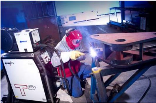
**Abb. 5:** Massive Hydraulikkonstruktion für Ballenpresse: Innovativer Fügeprozess – druckvoller Lichtbogen, guter Einbrand und gute Flankenbenetzung, schmale Wärmeeinflusszone, Sicherheit gegen Bindefehler
