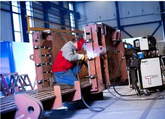
**Abb. 4:** Die Multiprozess-Stromquelle Taurus 451 beherrscht auch den Fügeprozess forceArc®
