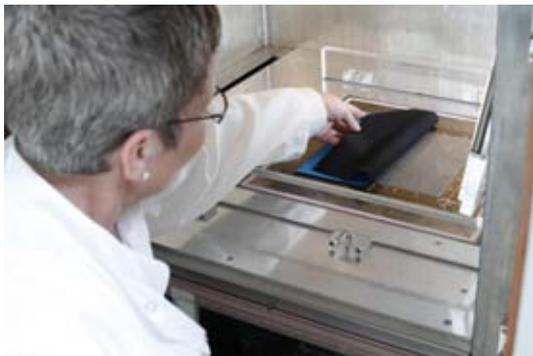
Unter definierten Klima- und Prüfbedingungen wird die Wasserdampfdurchlässigkeit eines Textils beim Ret-Test im Klimaschrank gemessen.
