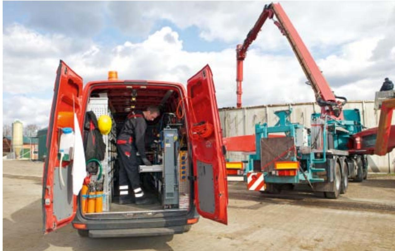
» Während die Schwimmschichten ausgebaggert werden, kann der Hydraulik Sofortservice bereits die defekte Schlauchleitung am Rühr-Ausleger austauschen.
