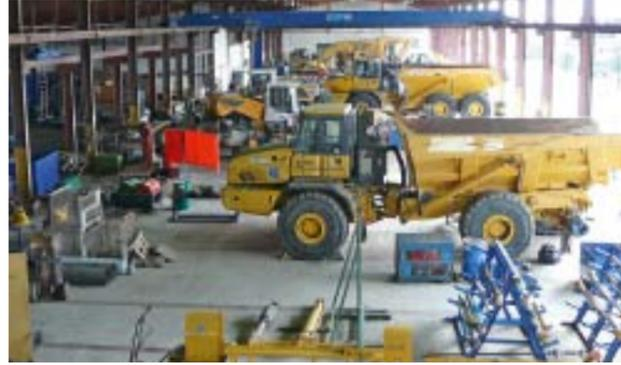
» In den hauseigenen Werkstätten werden die Fahrzeuge repariert und sämtliche Schlauchleitungen konfektioniert.
