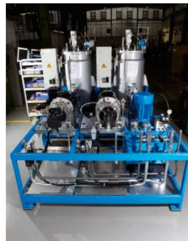
» Montage einer Polyurethan-Dosiermaschine der Baureihe TOPLINE HK mit modularer Behälterstation für die reaktiven Komponenten Polyol und Isocyanat (oben). Hochdruck-Axialkolbenpumpe vom Typ HQ für exakte und reproduzierbare Produktionsergebnisse (rechts).
