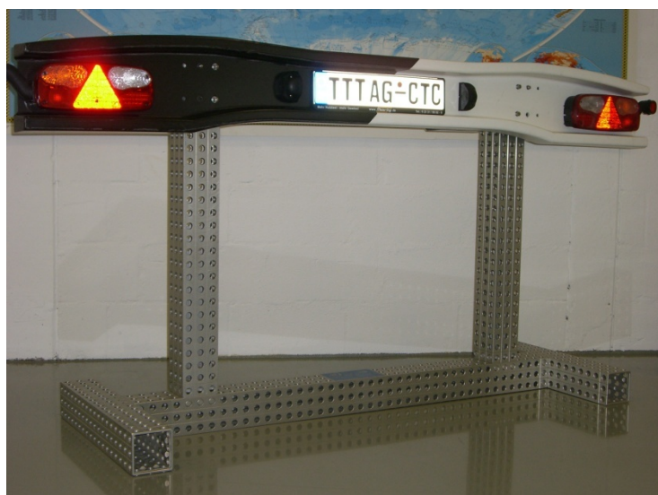
Foto: LKW Unterfahrerschutz aus kohlenstoffverstärktem Kunststoff (CFK) auf einer Vorrichtung des Alufix Baukastensystems von Witte
